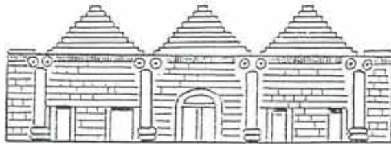
Fig 2. DVIN Palais patriarcal 5 e s Coupe longitudinale montrant les trois tetrapyles et leurs lanternes-cheminées. d'après Haroutiounian
